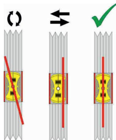
Процесс центровки также прост как и монтаж. Просто включите лазеры и смотрите на противоположный модуль. Лазерная линия должна совпадать с метками на шкале. При необходимости отрегулируйте шкивы.
