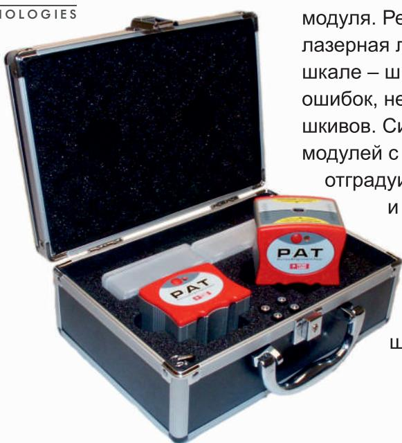
модуля. Регулируйте шкивы до тех пор, пока лазерная линия не совпадет с меткой на шкале – шкивы отцентрированы ! Нет риска ошибок, нет влияния качества поверхности шкивов. Система состоит из двух одинаковых модулей с питанием от батареек. Точно отградуированные шкалы позволяют быстро и просто отрегулировать механизмы.
