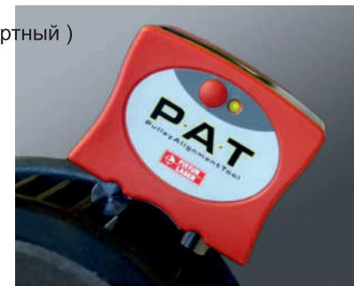
Простейший путь к центровке шкивов. Модули Fixturlaser PAT очень просто монтируются на шкивах. Подпружиненная опора модуля легко находит центр паза на шкиве. Надавив на модуль в направлении шкива, зафиксируйте модуль на шкиве при помощи магнитов.
